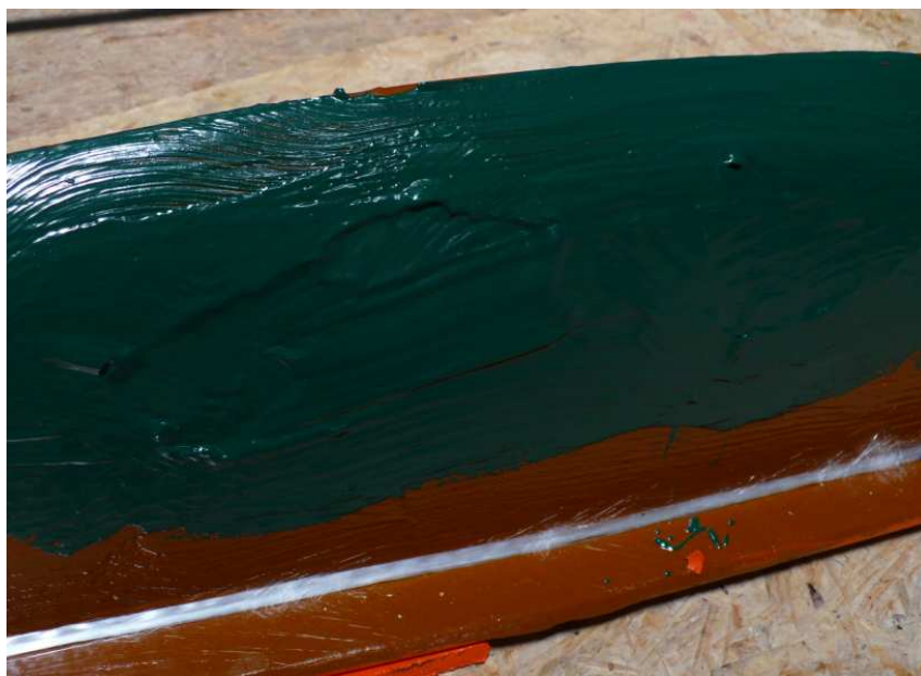
Figura 6.16: Correção com aplicação de gel sobre as bolhas retiradas, após cura da base.
