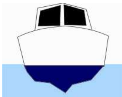
Figura 2.5: Exemplo de um barco com casco de fundo redondo (Associação do Conhecimento Náutico, 2007).
