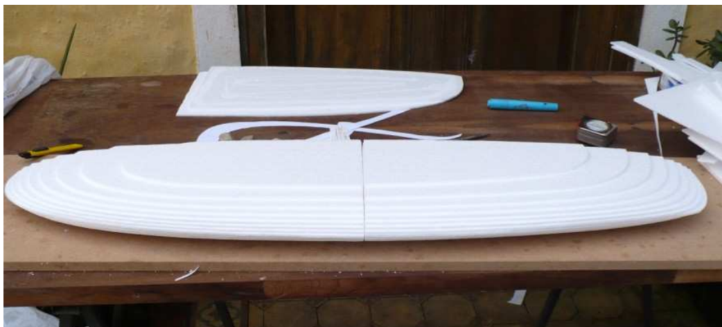
Figura 5.5: Seções de isopor do casco divididas em camadas de 5mm de espessura. Vista lateral.
