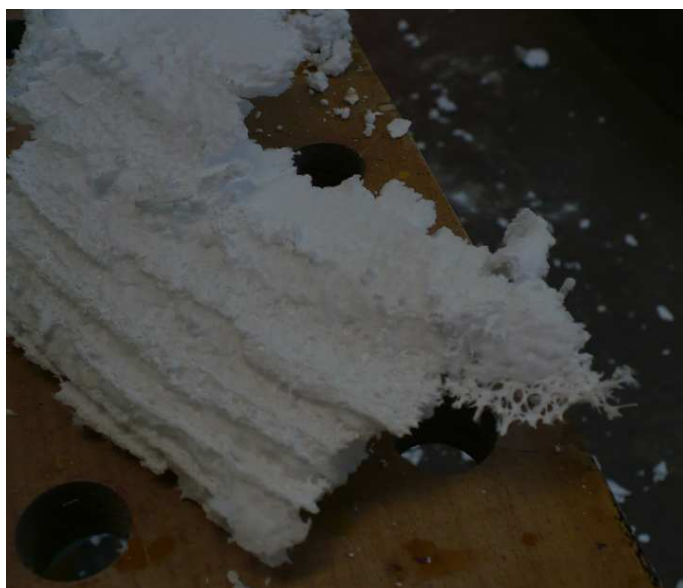
Figura 6.14: EPS do modelo após desmoldagem com pontos corroídos.
